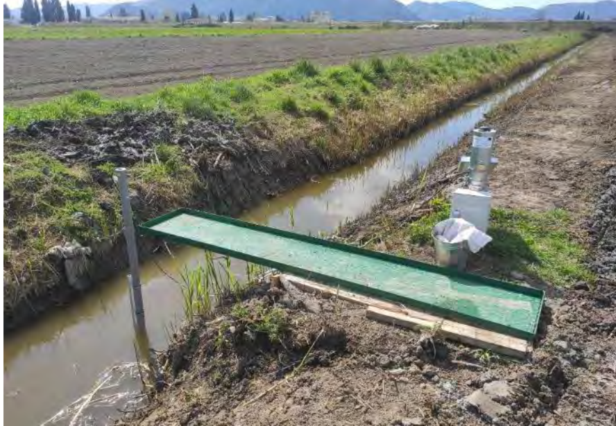
Slika 2. Višeparametarska sonda za praćenje zaslanjenosti površinskih voda instalirana u kanalu
