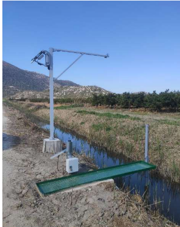
Slika 7. Beskontaktni radarski sustav za praćenje površinske brzine i razine vode u otvorenim vodotocima
