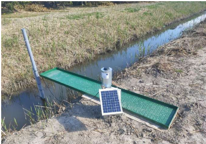
Slika 5. Višeparameterska sonda za praćenje stanja površinskih voda instalirana u kanalu
